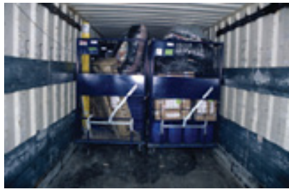
Optimale plaatsbenutting van de inwendige breedte van de vrachtwagens: De Corletten blokkeren elkaar en worden door een extra boksysteem vastgezet.
